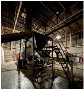
Incluye: Motobomba eléctrico, motobomba bencinero, chimenea, accesorios de funcionamiento completo, tolvas de alimentación primaria y cinta transportadora, tolva de alimentación secundaria y sinfín de alimentación automático, rastrillo interior automático, tablero eléctrico, ciclón colector de partículas, estanque de condensado, estanque de purgas, ablandador de agua.
